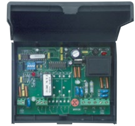
Dekooderikotelo Koodinäppäimistöille CTR 1b-1, CTR 3b-1, CTV 3-1, CTP 3
