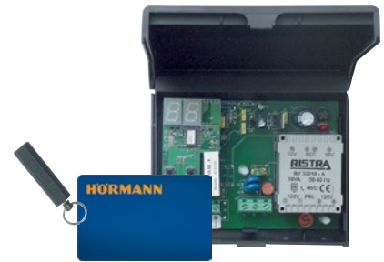
Transponderilukija TTR 1000-1 1 toiminnolle, transponderiavaimen tai transponderikortin avulla, voidaan tallentaa jopa 1000 avainta tai korttia
